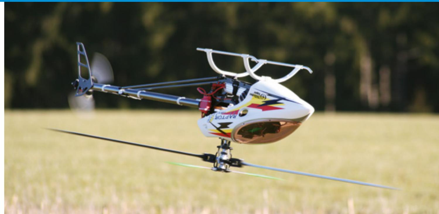
*Brushlesstechnik und LiPos ermöglichten den Betrieb von 3D-Helis vollelektrisch*
