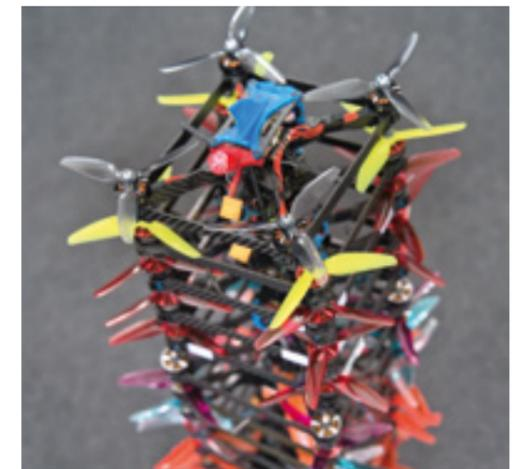
Sogenannte Race-Drohnen wurden erst durch Entwicklungen wie LRK-Motoren und LiPo-Akkus möglich
