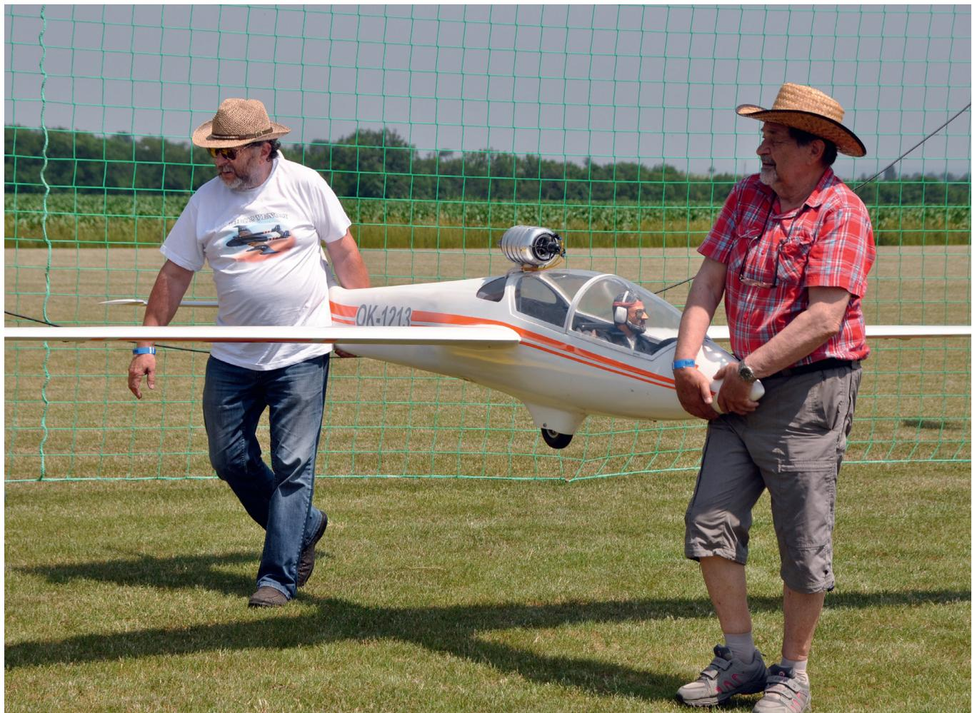
*Kein Prop in der Nase, kein Klapptriebwerk, sondern Turbine geschultert – auch so etwas ist heutzutage keine Seltenheit mehr*
