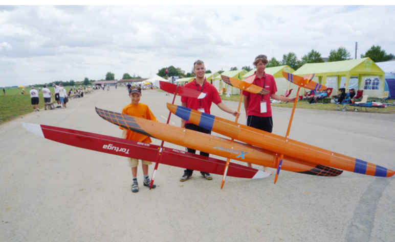
Im F3J-Segelflug kommen überwiegend hochmoderne Flugmodelle aus Faserverbundwerkstoffen zum Einsatz
