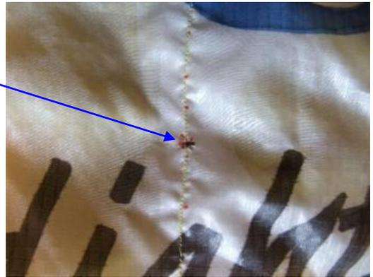
Die Fangleinen werden am Schirm mit einer Nadel eingeleint, doppelt geknotet, mit Uhu-Hart gesichert oder eingespleißt (wird noch erläutert).
