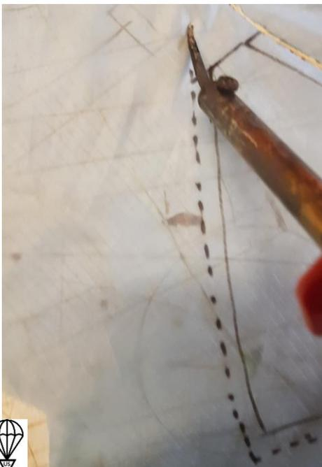
Freihändig mit dem LötKolben sechs Teile ausschneiden.
