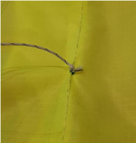
Die Fangleinen werden an der Fallschirmunterseite eingeknotet (links) oder eingespleißt (unten). Dabei wird die Fangleine an der jeweiligen Rippe mit der Unterseite sehr knapp mit einer Nadel durchgezogen. Die Markierung an der Fangleine beachten und dort am Schirm verknoten.
