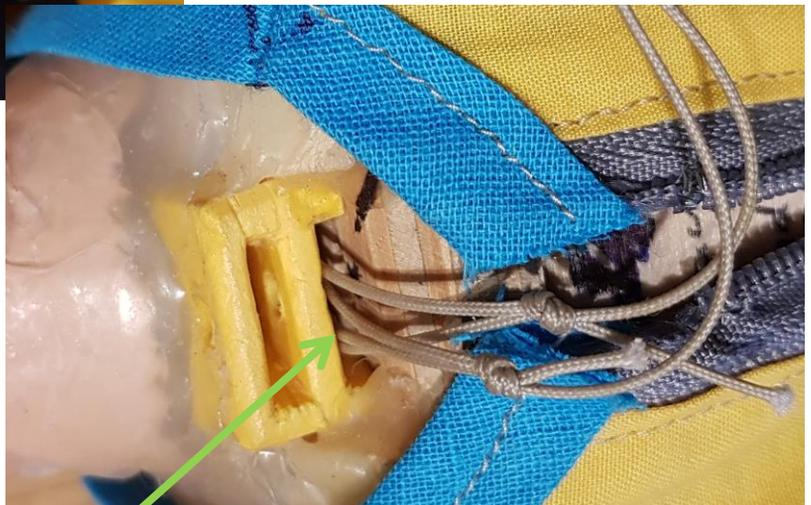
Die Schlaufen der beiden Vorbremseleinen in die untere Auslösevorrichtung führen und verriegeln.
