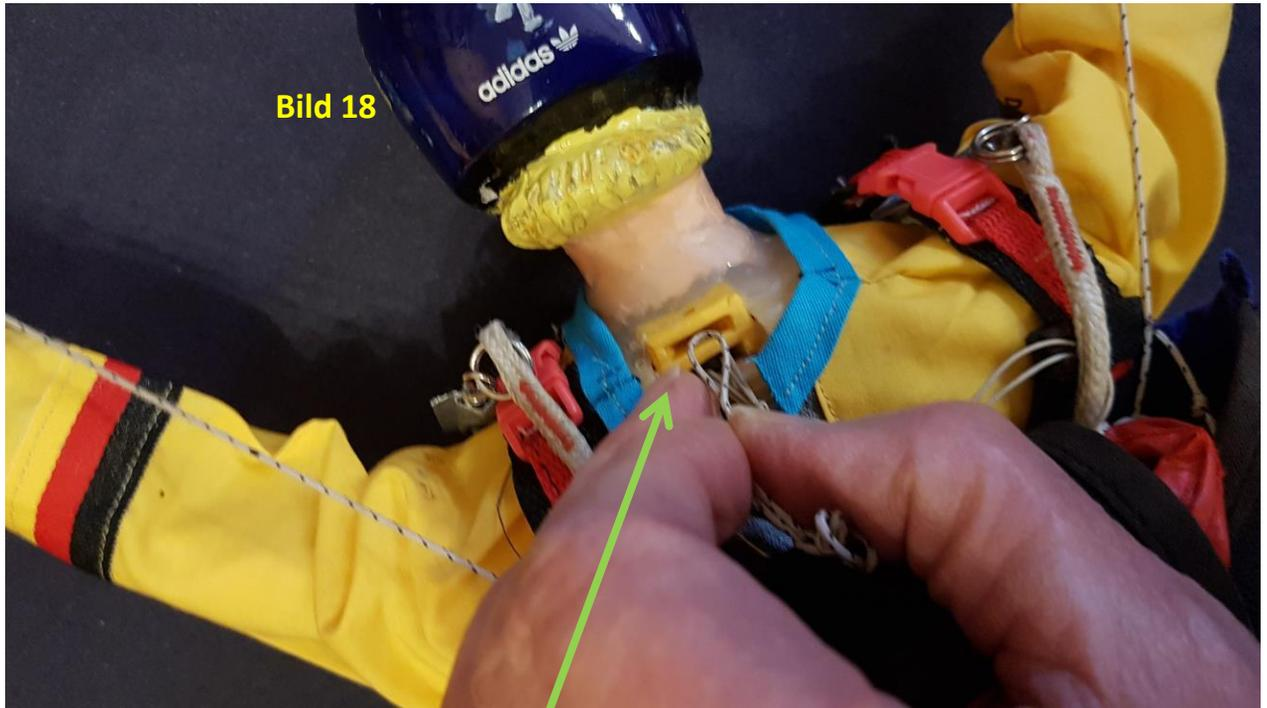
Die Auslöseschleufe wird in die obere Auslösung eingeführt und verriegelt.
