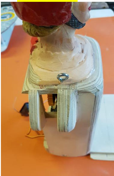
Die Ösenschrauben für die Schirmbefestigung werden angebracht.
