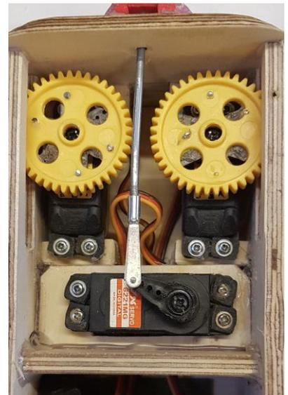
Einbau der Servos in folgender Reihenfolge: Armservos, danach das Auslöseservo.
