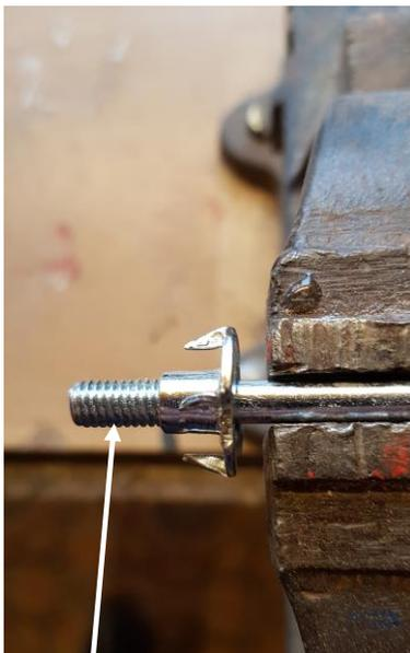
Eine Einschlagmutter bis zum Gewindeende aufschrauben und den überhängenden Teil absägen.
