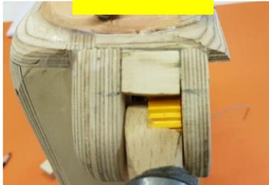
Der Oberarm soll eine Stellung von 30° haben. Mit einem Bleistift wird diese Stellung markiert und Teil 47 passend eingeklebt.
