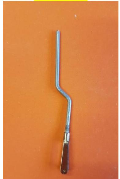
Schubstange mit einem Knick versehen und mit Übermaß ablängen. Gabelkopf anbringen.
