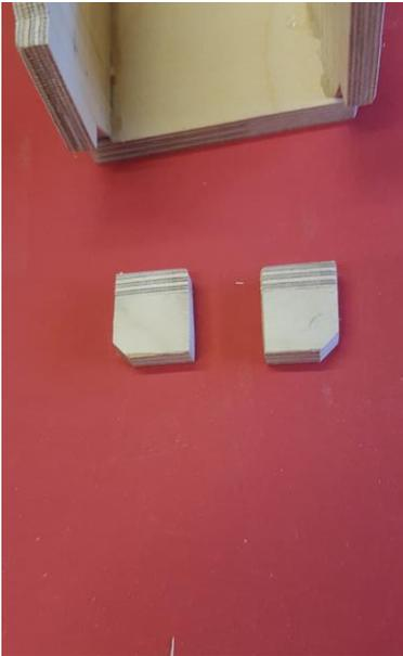
Servoauflage Teil 11 und Teil 11a verkleben und verschleifen und eine Ecke ca. 3mm anschrägen.
