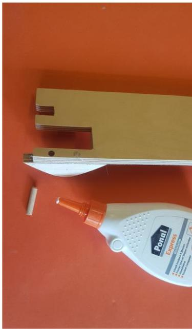
Mit zwei 5 mm Holzdübel wird diese Klebung verstärkt. Nach der Verklebung bohren und die Dübel setzen.
