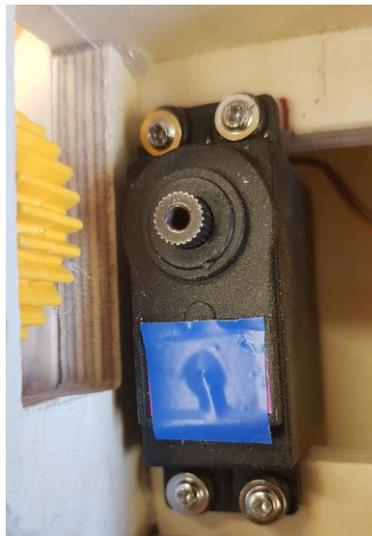
Das Zahnrad vom Servo abnehmen, ohne das Servo zu verschieben (eine Markierung setzen) und dann festschrauben.
