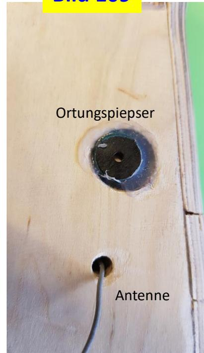
Zu empfehlen ist der Einbau eines Ortungspiesers dann, wenn eine Ortung über die Fernsteueranlage nicht möglich ist.
