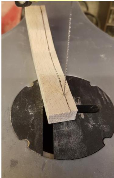
Die Unterarme werden mit der Säge auf 15 mm verjüngt (eine dünnere Leiste zu kaufen wird dadurch vermieden).
