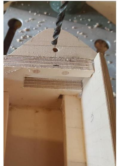
Die Armlager mit einem 4 mm Bohrer setzen.
