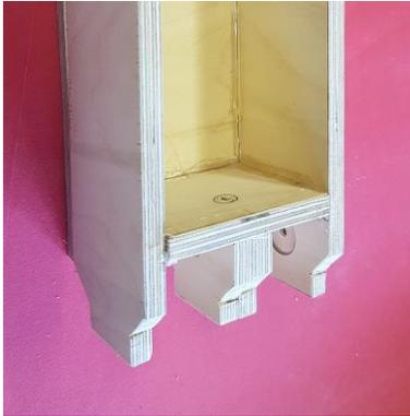
Bodenplatte an der angezeichneten Stelle einkleben.
