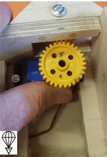
Mit dem Daumen das Servo an das Zahnrad des Armes drücken und das Servo auf der einen Seite anschrauben. Das Servo kann man und sollte ohne die Gummitüllen angeschraubt werden.
