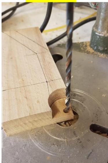
Die Tiefe für das Zahnrad beträgt 12mm, danach kann die 4mm Bohrung erfolgen.
