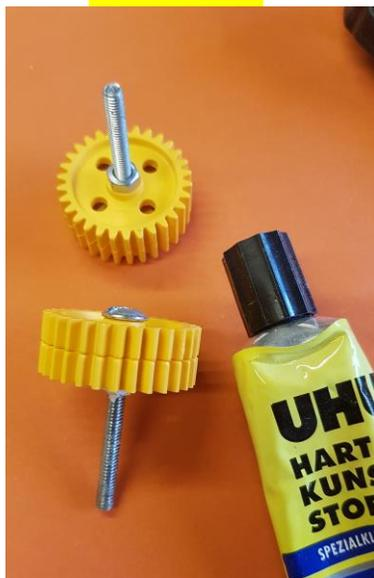
Beide Zahnräder mit UHU-Kunststoff verkleben und mit M4 Schraube fixieren. Zähne müssen fluchten.
