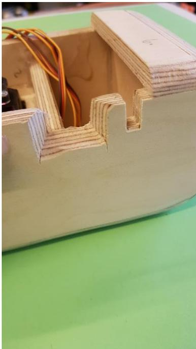
Unter dem Schalter kann eine Ausparung für die Ladebuchse erfolgen.
