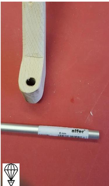
Zwei Lager für das Bein je 25 mm lang aus dem ALU-Rohr fertigen, einkleben und verschleifen.
