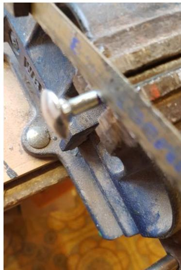
Danach die Schraube am Kopf ablängen – **Gesamtlänge der Schraube 95 mm.**
