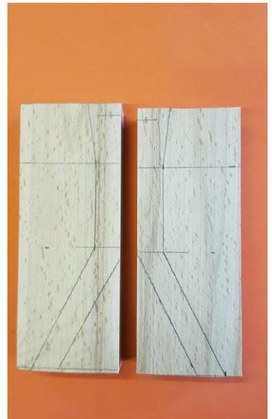
Je ein Arm (links und rechts) wird aufgezeichnet. Teile 18 und 18a bzw. 19 und 19a in einem Stück zeichnen – werden später getrennt.
