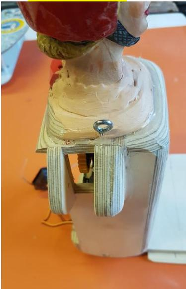
Die Ösenschrauben für die Schirmbefestigung werden angebracht.
