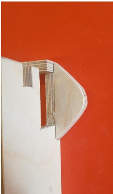
Das einzelne Teil 8 wird mit 9 mm Überstand (Behelfsstück) und Heißkleber angeklebt.
