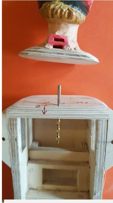
Als Führung dient der 3mm Bohrer. Das Kopfteil wird mit Heißkleber versehen und fest aufgesetzt.
