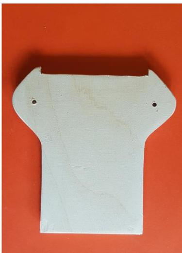
Im Abstand der Armlager innen eine kleine Vertiefung auf 10 mm aufbohren und verschleifen so das der Schraubenkopf versenkt wird.
