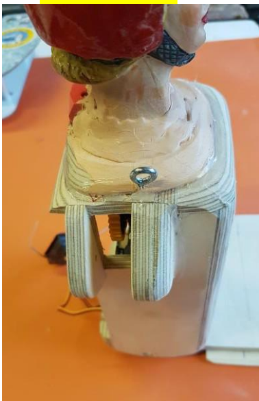
Die Ösenschrauben für die Schirmbefestigung werden angebracht.
