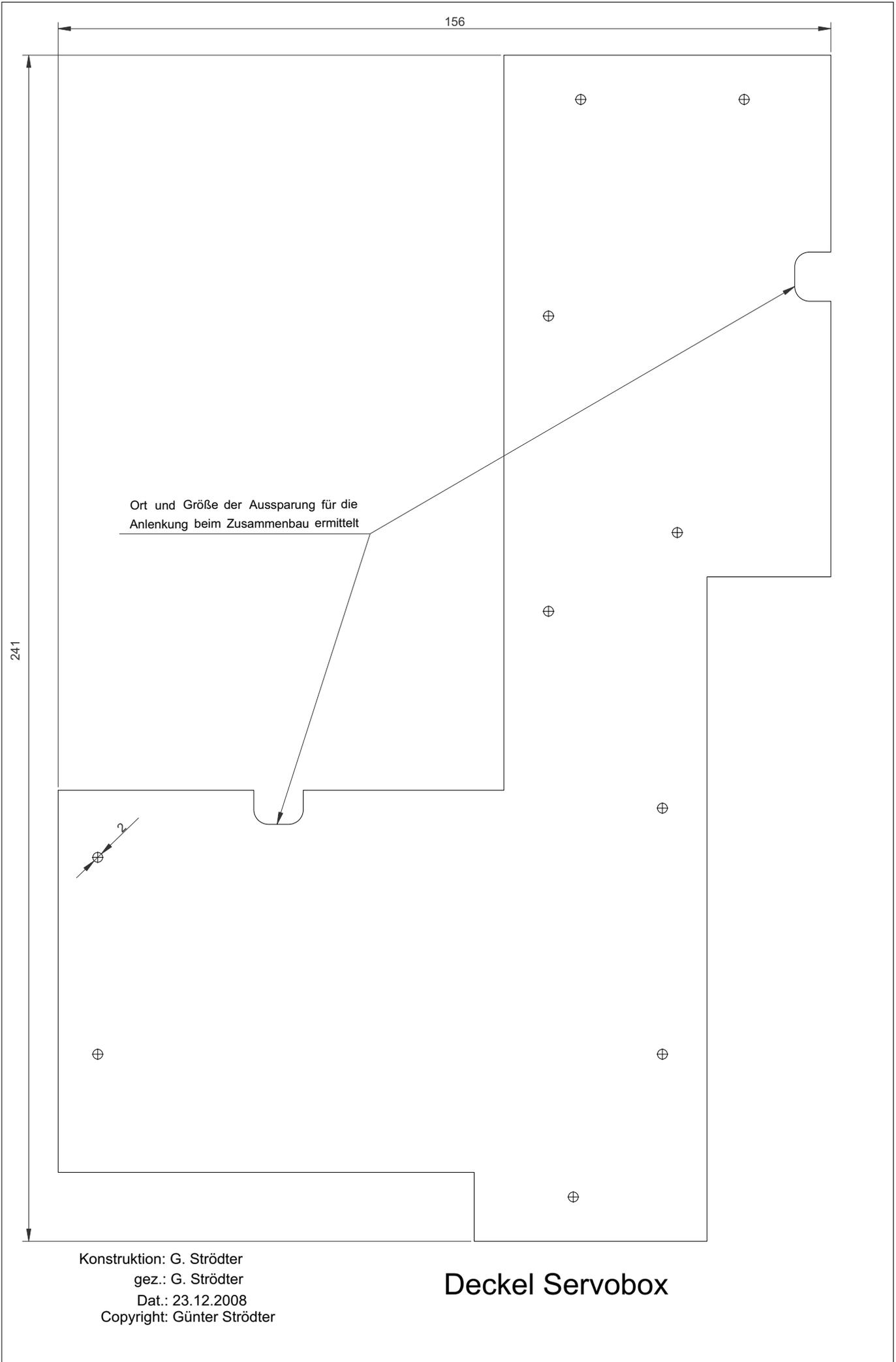
Ort und Größe der Aussparung für die Anlenkung beim Zusammenbau ermittelt
